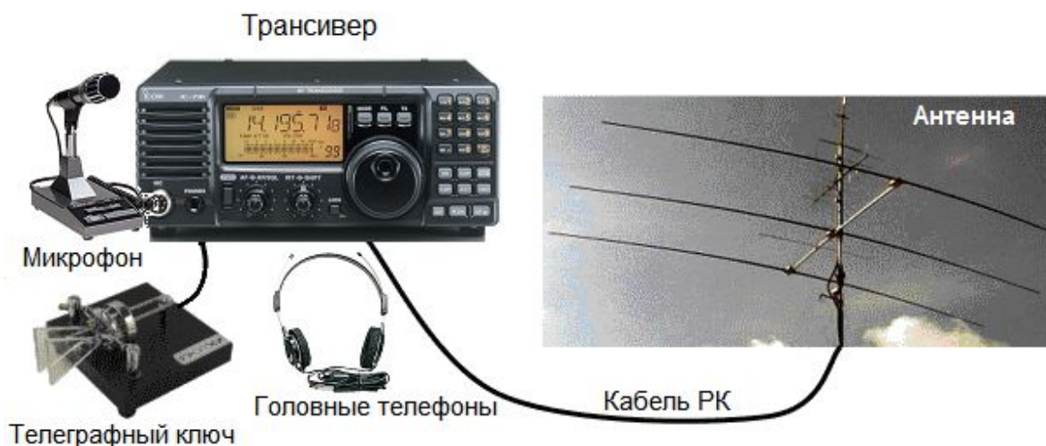
Рис.2.2. Элементы любительской радиостанции
