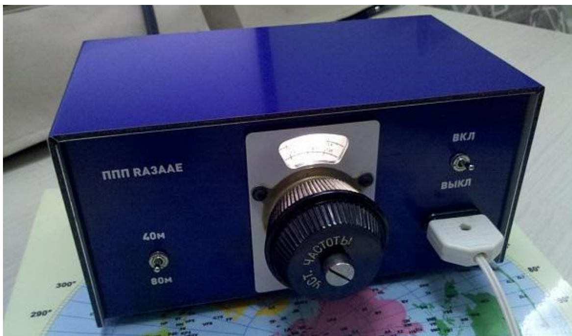
Рис.2.7. Приемник прямого преобразования В.Т. Полякова (РАЗААЕ) на 40 и 80 м.
