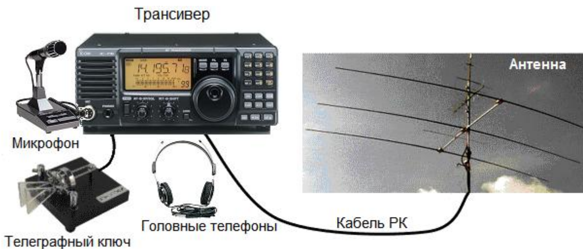
Рис. 2.3. Элементы любительской радиостанции
